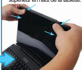
Sur les deux côtés, pousser l'arête du verrou supérieur vers le haut et tirer vers l'avant sur le coin arrière de la tablette.
